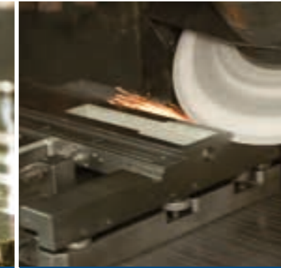
Schleifen d. Schwalbenschwanzführung
