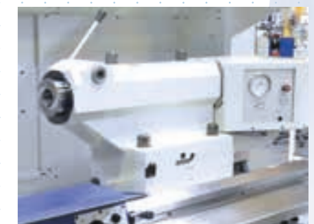
Reitstockpinole hydraulisch betätigt
