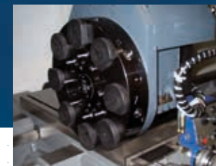
8-fach-Scheibenrevolver mit angetriebenen Werkzeugen, Schaft-ø 40 mm
