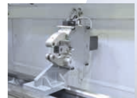
Feststehende, selbstzentrierende Lünette, hydraulisch betätigt
