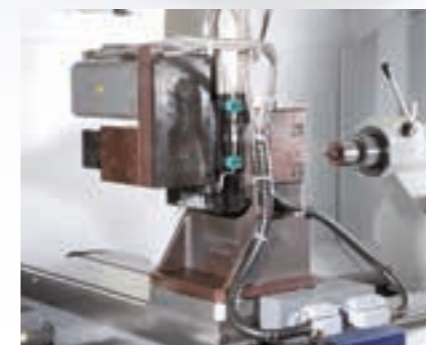
Y-Achse 200 mm Hub (nur bei E110/E120)
