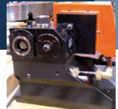
Werkzeugträgerkopf mit angetriebenen Werkzeugen, Aufnahme Capto C8
