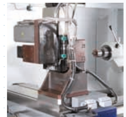
Y-Achse mit 200 mm Hub
