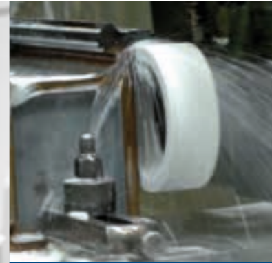
Schleifen eines Maschinenbettes
