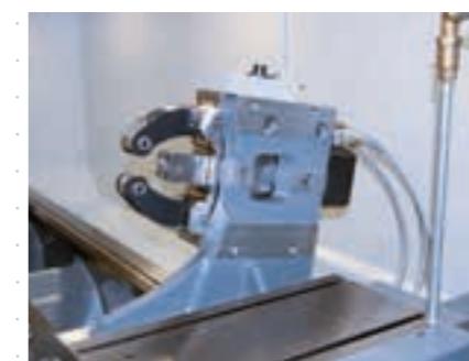
Mitlaufende, selbstzentrierende Lünette, hydraulisch betätigt
