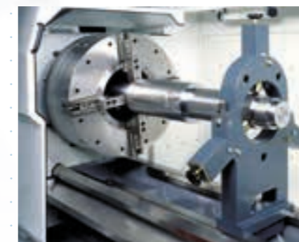
Pneumatisch betätigtes Vorderendfutter und feststehende Lünette
