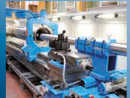
Verstärkter Bohrbock mit zusätzlicher Abstützung und Aufnahmebohrung 160 mm
