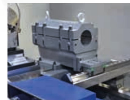
Bohrbock mit zusätzlicher Abstützung
