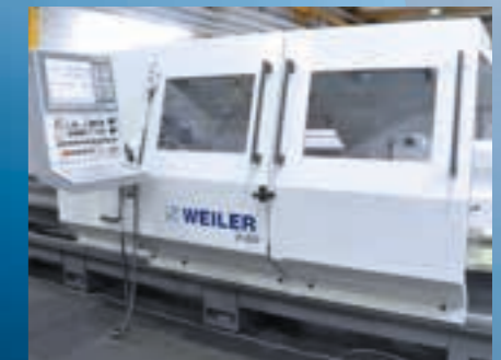
Ausführung mit zweiter Schiebeschutzhaut und Spritzwand
