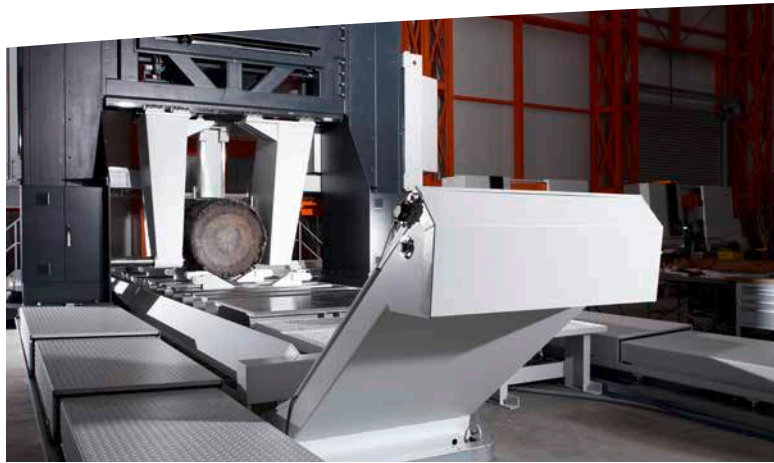
Späneförderer mit 1.250 mm Förderbreite und 1.100 mm Auswurfhöhe
