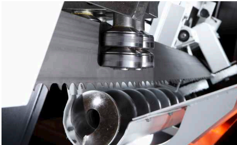
Schneckenförderer im Sägekopf mit doppelter Spänebürste
