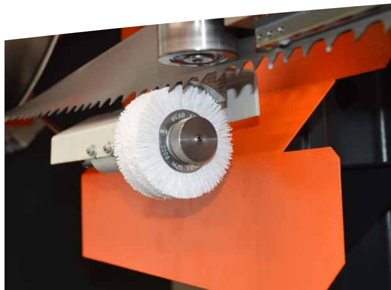
Selbstjustierende, motorisch angetriebene Späneräumbürste
