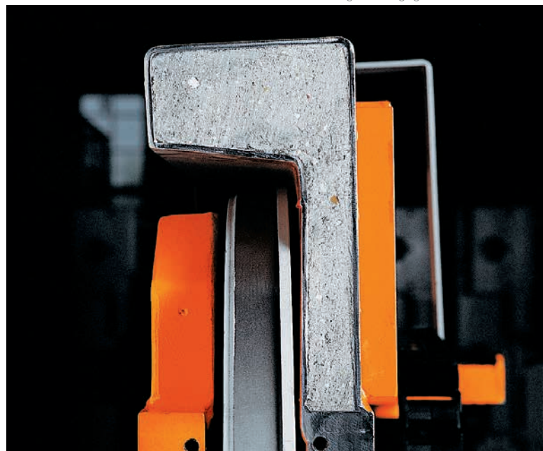
Moderner Werkzeugmaschinenbau: mit Mineralguss ausgegossener Stahlmantel
