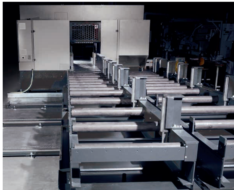
Doppelrollenbahn für automatischen Materialwechsel (win 3.6, 4.6, 5.6 und win tube 5.0)
