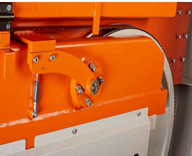
Stabiler Sägerahmen mit doppelter Laufradlagerung.
