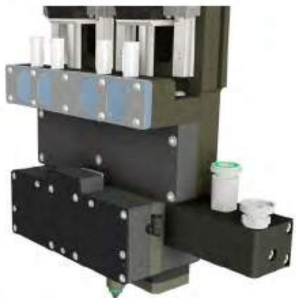
Ergebnis: Dosierer an Hubeinheit befestigt.
