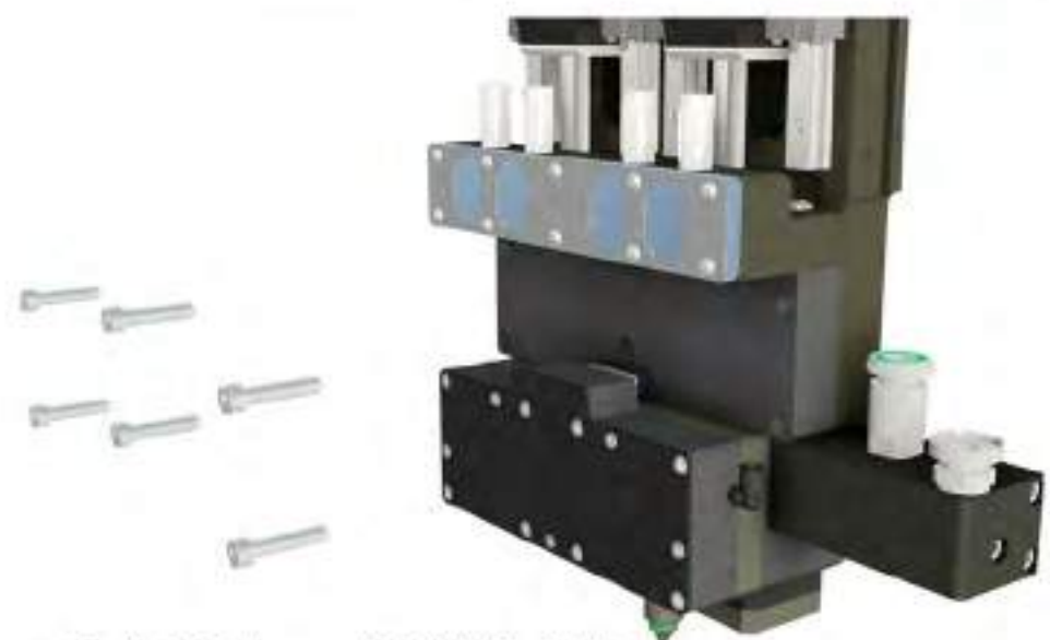
Ergebnis: Dosierer an Hubeinheit befestigt.
