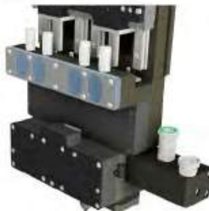
Ergebnis: Dosierer in die Hubeinheit eingesetzt.
