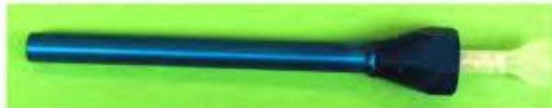
Abb. 10-4: Mischrohr in Zentrierrohr stecken
