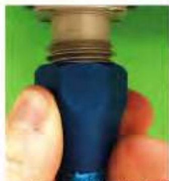
Ergebnis: Mischrohr mit Zentrierrohr ist am Dosierer befestigt.
