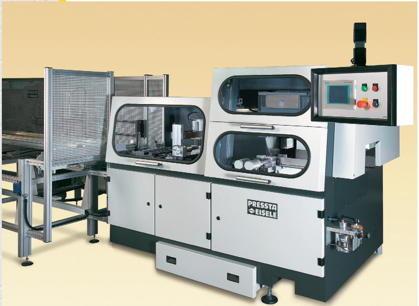
Kreissägevollautomat PROFILMA 600 R mit Zufuhrmagazin
