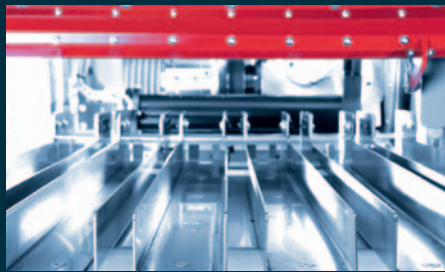
Mehrbahnige Zuführrinne für rotationssymmetrische Rohteile; die Rohteillänge bestimmt die Anzahl der Zuführinnen.
