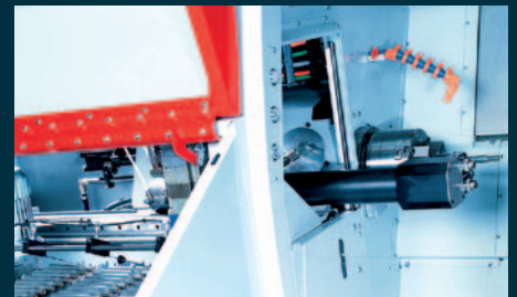
Vollautomatische Beladung von Wellen. Zuführung über Taktband, Abführung über die Fertigteilauffangvorrichtung.
