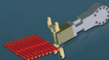
2-Finger-Kniehebelgreifer für die Beladung von Wellenteilen
