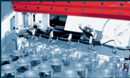
Taktförderband für die orientierte Rohteilzuführung mit großem Teilevorlauf.
