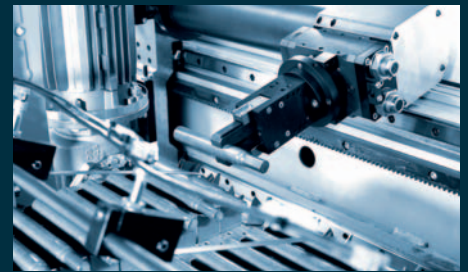
Taktförderband mit Prismenaufgaben für unterschiedlich vorgeformte Wellenteile.
