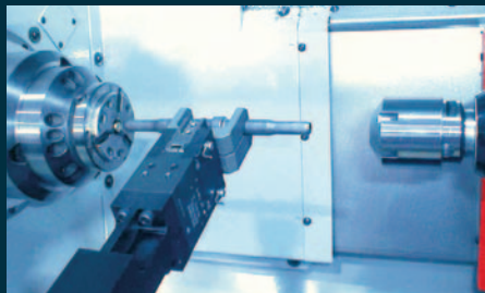
Wellengreifer für die automatische Beladung von vorgeformten Wellen.
