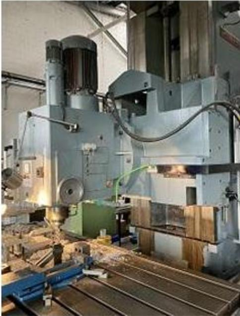
Frässpindelkasten , rechte Seite Ölschauglaser und Deckel im Getriebekasten
