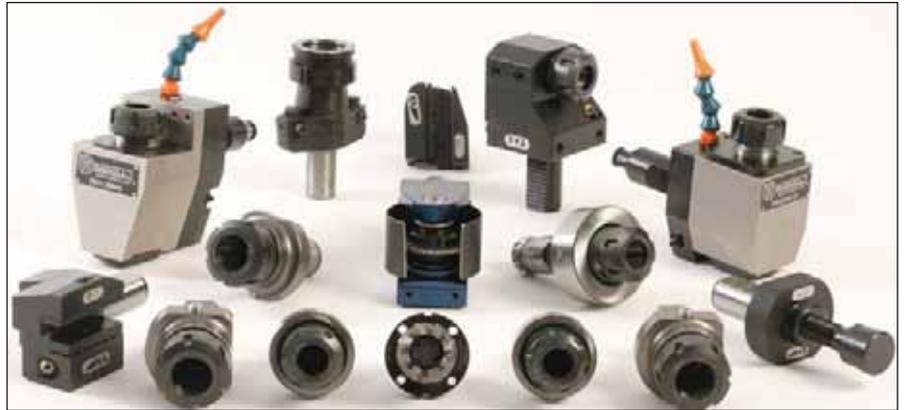
La torreta de 8 estaciones del WIN, puede acoplar portaherramientas comerciales VDI-30 y portaherramientas con mango  $\varnothing$  25,4 mm. Además, tenemos una extensa gama de portaherramientas rotativos, para el mecanizado de las piezas más complejas.
