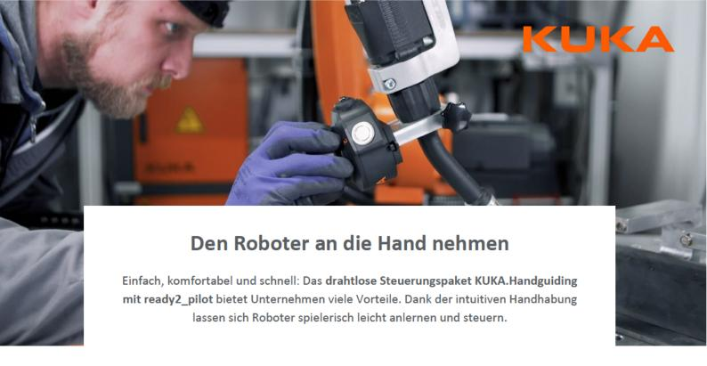
Als weltweit erstes Steuerungspaket seiner Art macht KUKA ready2\_pilot die Steuerung von Robotern spielerisch leicht. **Das Paket ist schnell am Roboter montiert und ohne aufwendiges Programmieren direkt einsatzbereit.** Über einen Commander, einer Art 6D-Maus, können Mitarbeiter dem Roboter-Kollegen genau zeigen, was er zu tun hat – indem sie ihn per Hand an einem Werkstück entlangführen.
